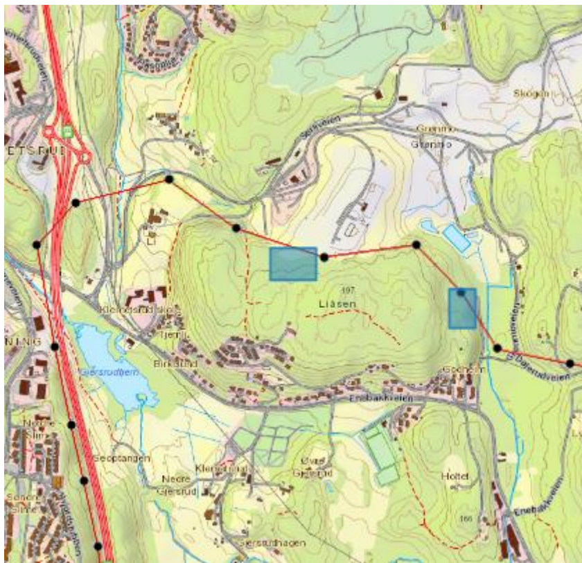
Figur 3 Alternative plasseringer for en ny sentralnettstasjon ved Liåsen. Begge plasseringene er kompaktanlegg, og plassert langs 420 kV ledningen Follo-Frogner (rød linje i figur)
