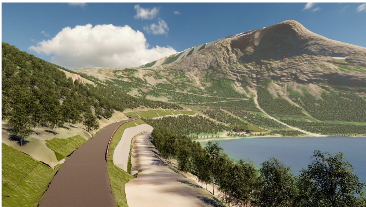
Figur 6 Nedre del av stasjonsvegen, slik den vil bli utformet med støttemur ned mot veg til eksisterende stasjon, og begrenset med skjæring i overkant. Illustrasjon fra 3D-modell.
