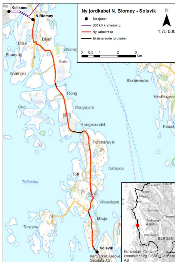
Figur 2: 300 kV sentralnett Little Sotra – Kollsnes med innkuttet kabelanlegg fra Solsvik til Nordre Blomøy.
