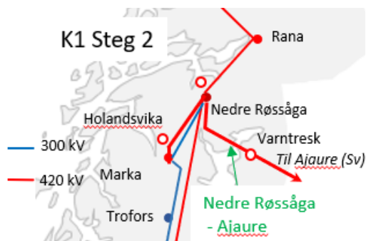
Figur 21: Konsept 1 steg 2 – Spenningsoppgradering fra Nedre Røssåga til Ajaure i Sverige til 420 kV (forsert).
