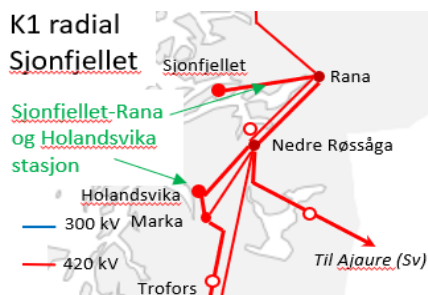
Figur 24: Ny produksjonsradial til Sjonfjellet vindkraftverk dersom denne skal realiseres. Kundespesifikt anlegg.
