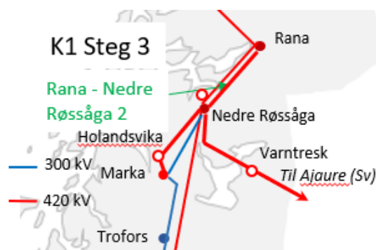
Figur 22: Konsept 1 steg 3 - Ny 420 kV forbindelse mellom Nedre Røssåga og Rana.
