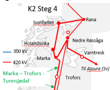
Figur 29: Konsept 2 steg 4 – Spenningsoppgradering til 420 kV (forsert) sørover til Midt-Norge.
