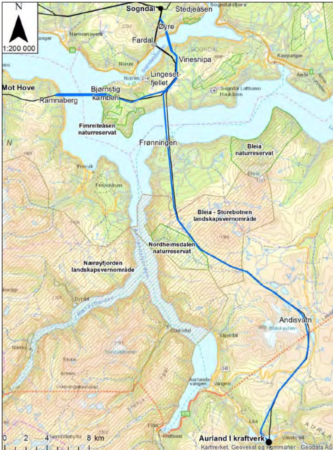
Figur 2-4. Konesjonsgitte ledninger markert med blå strek. Svart strek markerer dagens ledninger som skal rives mellom Sogndal og Aurland samt mellom Sogndal og Ramnaberget. Kart hentet fra Statnett sin konsekvenssøknad fra februar 2019.
