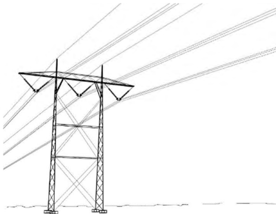
Figur 1-17. Normalt mastebilde for 420 kV bæremast med triplex strømførende liner. Illustrasjon: Statnett.
