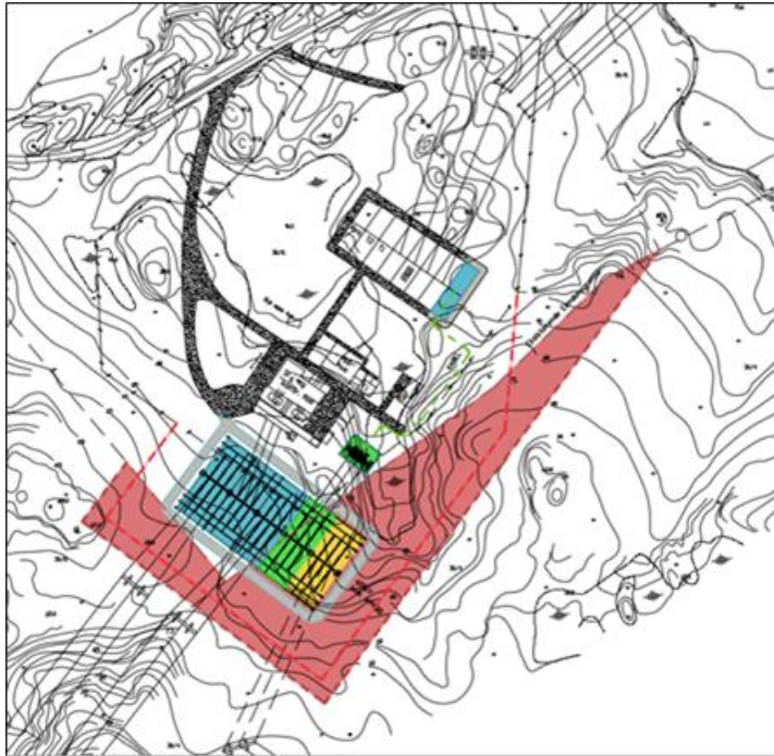
Figur 4. Nytt utvidet apparatanlegg og ny transformator sør for eksisterende stasjon. Felt som er merket med gult er omsøkt i konsesjonssøknaden for Balsfjord-Hammerfest. For fullstendig situasjonsplan, se vedlegg 3.
