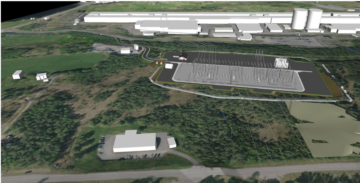
Figur 1: Visualisering av omsøkte tiltak sett fra øst. Visualiseringen er georeferert, men kun en modell og gir ikke en nøyaktig gjengivelse av hvordan transformatorstasjonen eller omgivelsene vil fremstå.
