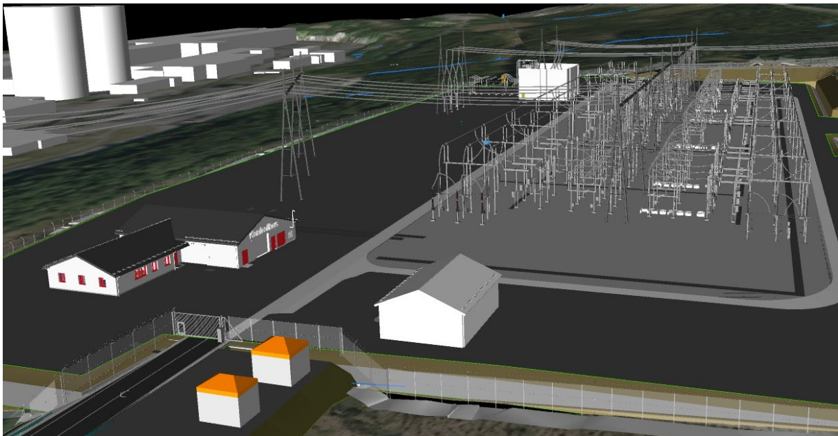
Figur 2: Visualisering av deler av omsøkt stasjonsområde inkludert kontrollhus sett fra sør. Bildet er en visualisering og farger og omgivelser vil fremstå annerledes i virkeligheten.
