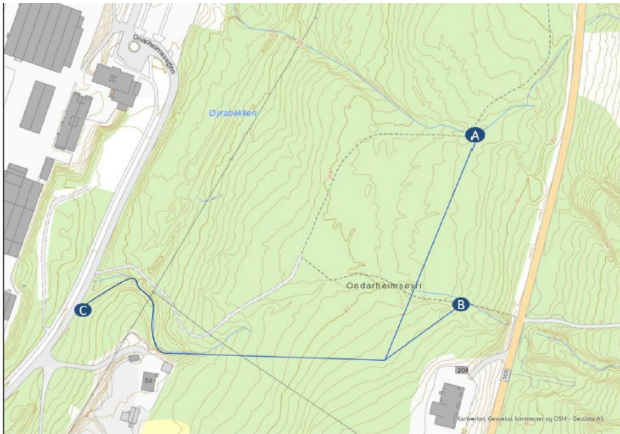
Figur 5: Øyrabekken legges om ca. fra punkt A og ledes sørover til Ondarheimsøyri som legges om fra punkt B. Fra møtepunktet ledes begge vannstrengene ned til punkt C.
