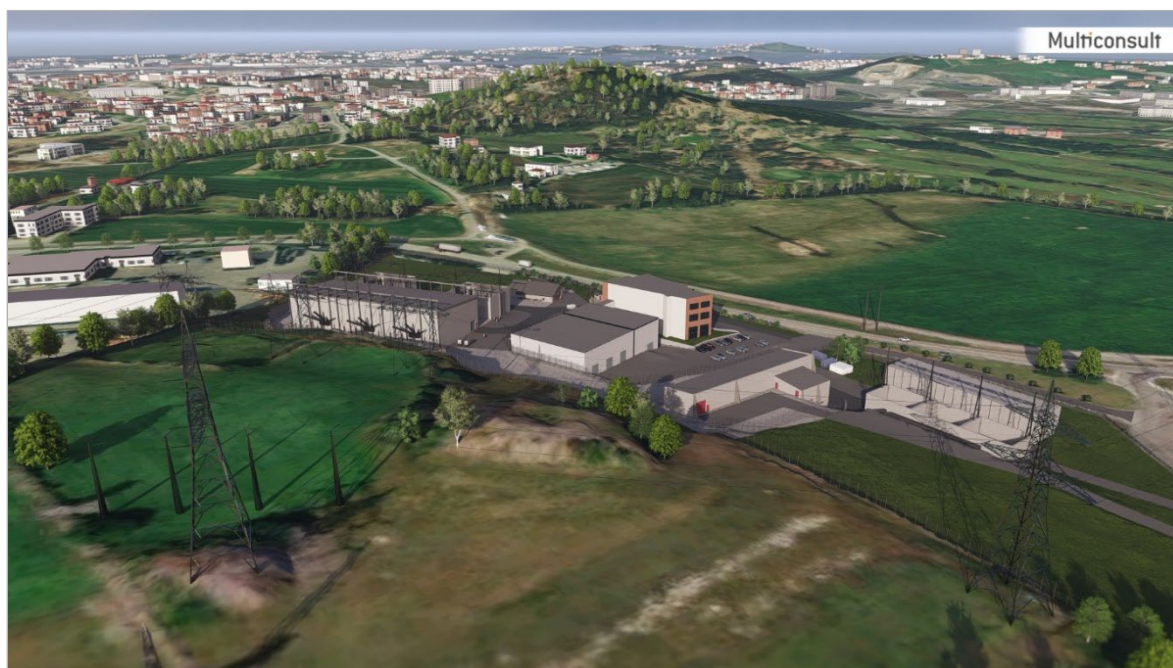
Figur 4 De planlagte enfasemastene og ny dobbeltkursmast, vises henholdsvis nede til venstre og til høyre i figur. De nye forankringsmastene kan skimtes sør for Humleberget transformatorstasjon. Figur ses fra sør mot nord.
