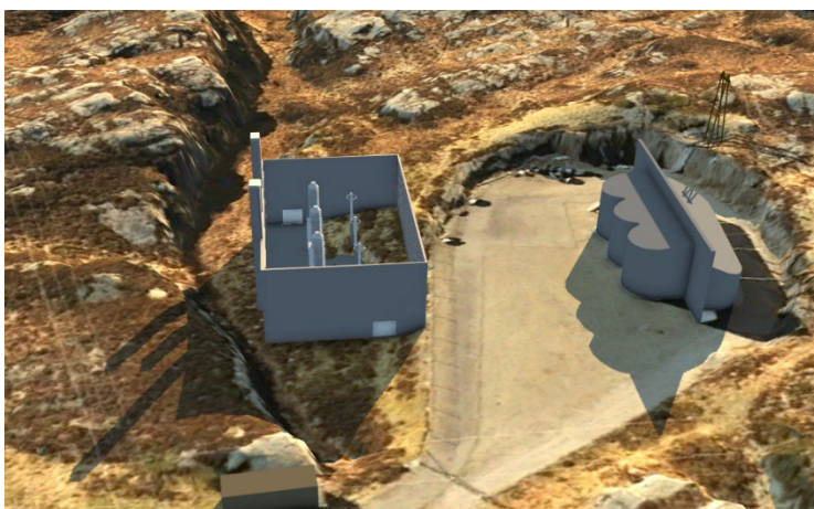
Figur 10: 3D-visualisering av eksisterende anlegg (høyre) og ny muffestasjon (venstre) på Nordre Blomøy. Grunnen rundt ny muffestasjon vil bli opparbeides. Arealbruken er vist på figur 11.
