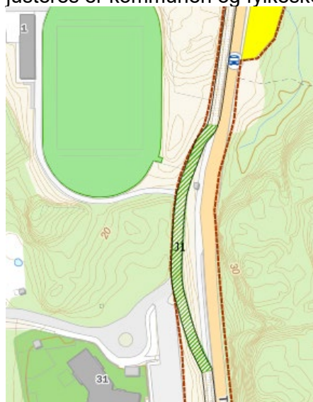
Figur 5: Illustrasjon viser justering av kabeltraséen. Blåstripete strek viser konesjonsgitt trase, og rødstripete strek viser justeringen. Arealbruksgrensen og riggplassene R10 og R11 vises også på kartutsnittet
