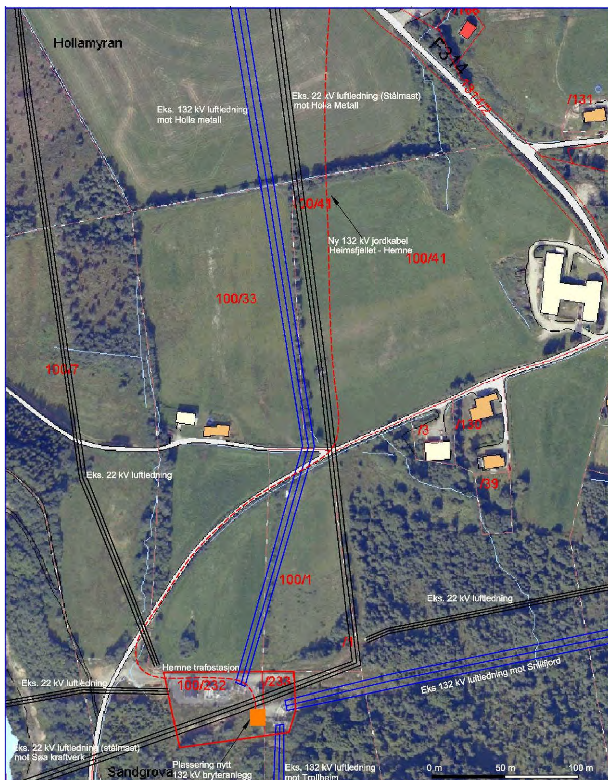
Figur 8. Hømne transformatorstasjon med eksisterende ledninger og trasé for kabel fra Heimsfjellet vindkraftverk.
