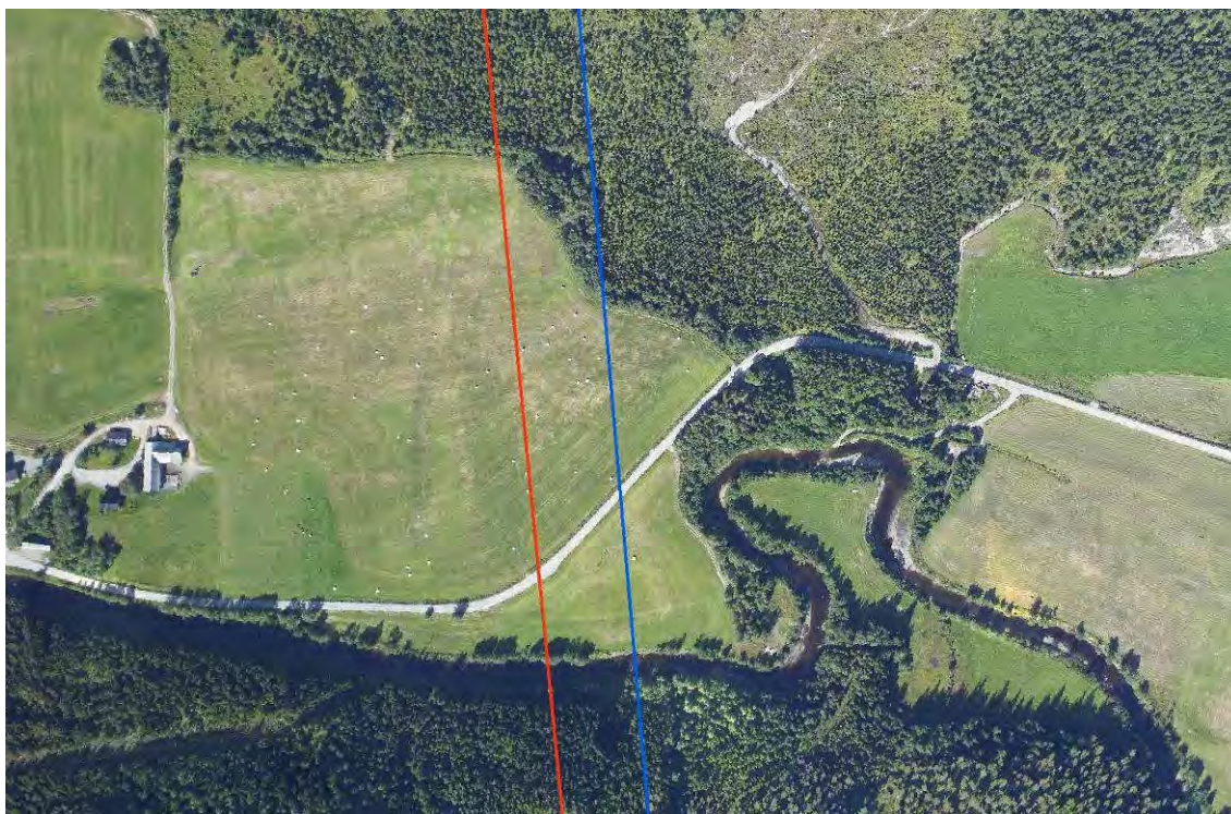
Figur 49. Kryssingen av dyrket mark inn mot Snillfjord A ved nettilknytning av Remmafjellet. 132 kV (rød) og 420 kV (blå).
