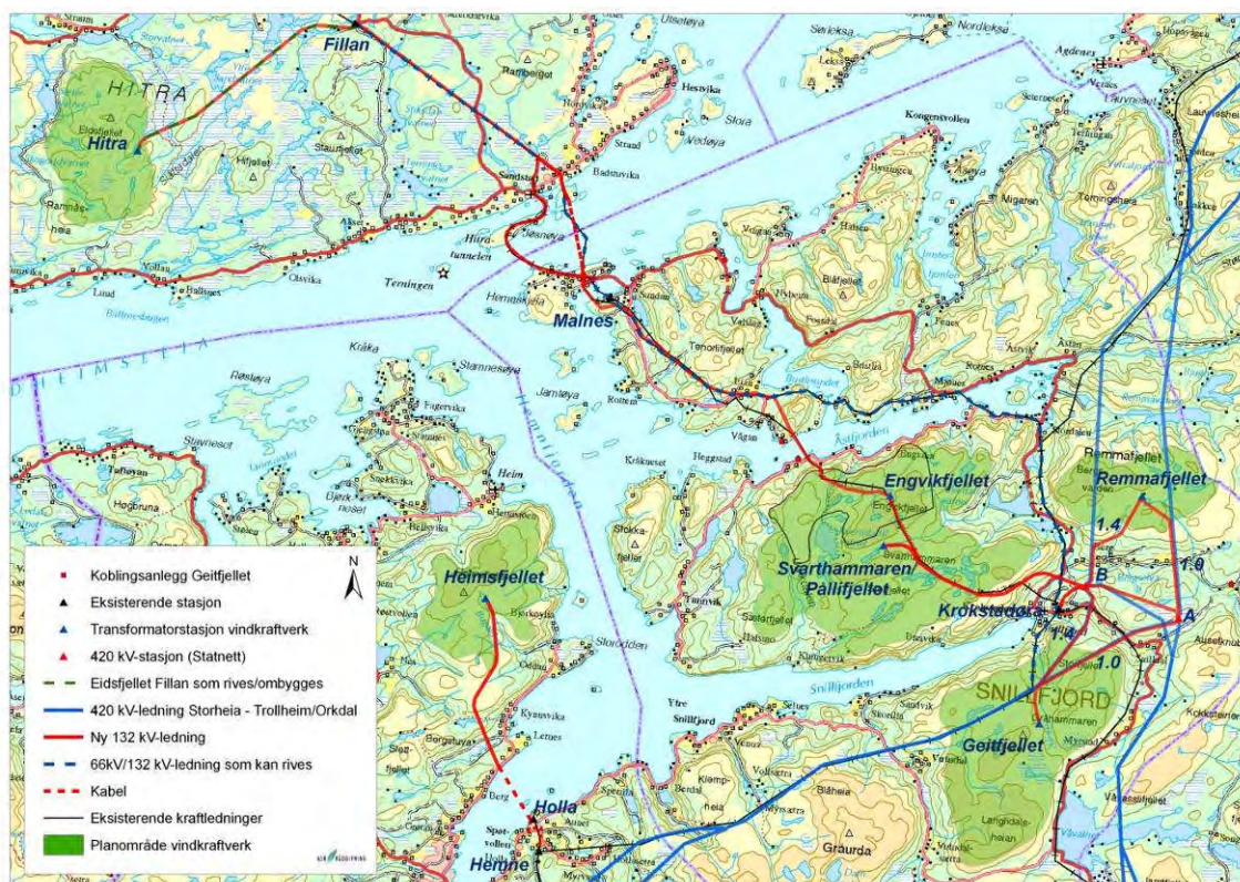
Figur 19. Planlagt 132 kV-nett fra vindkraftverkene og traseer for ny 420 kV-ledning fra Storheia på Fosen til Trollheim og eller Orkdal. De to alternative stasjons plasseringene (A og B) for ny 420 kV stasjon i Snillfjord er vist med røde trekkanter.
