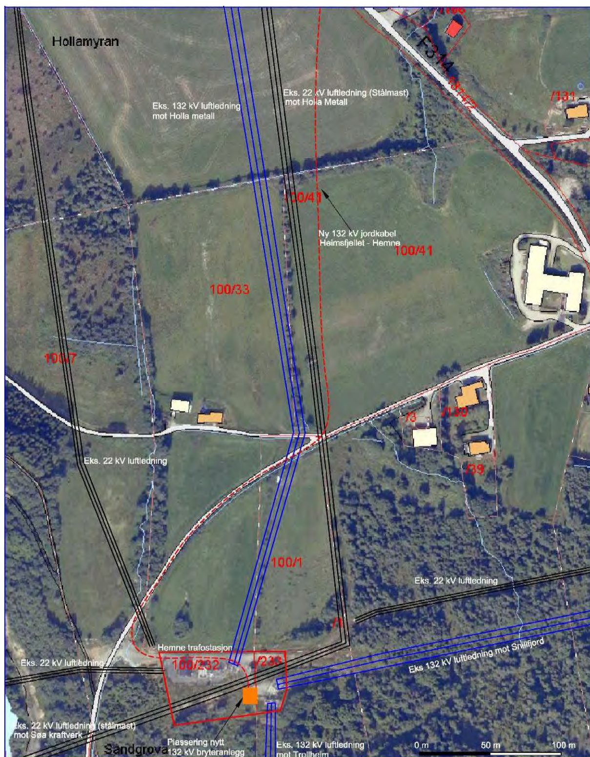
Figur 8. Hemne transformatorstasjon med eksisterende ledninger og trasé for kabel fra Heimsfjellet vindkraftverk.
