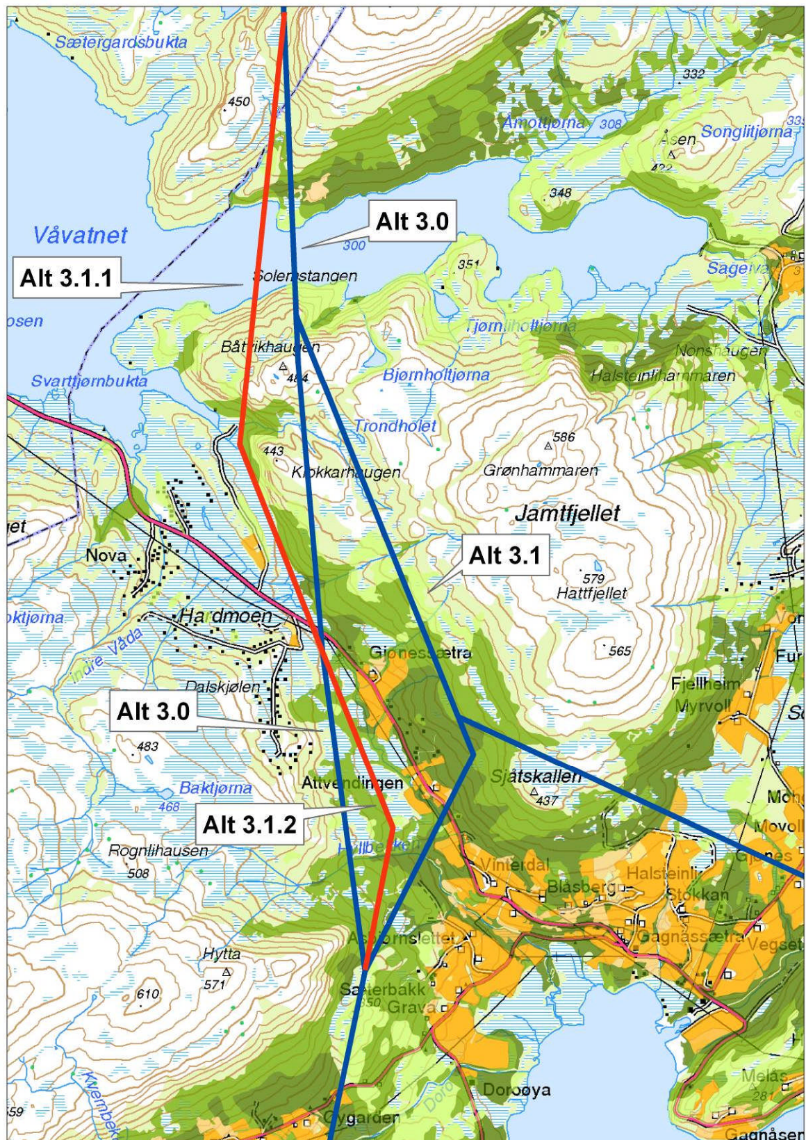
Figur 1. Trasékart som viser nytt alternativ 3.1.1-3.1.2 samt landbruksinteressene i området. Jordbruksarealer er gitt i oransje, mens grad av grønnfarge angir bonitet.
