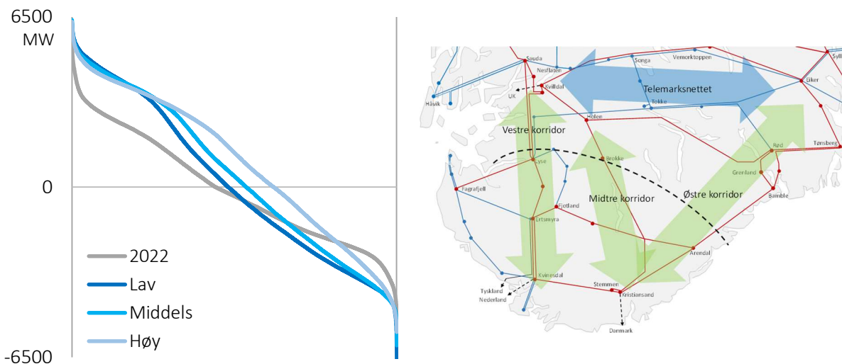
Figur 2-12 Varighetskurve for flyt over ledningene fra sør til nord på Sørlandet. Sum kraftflyt over ledningene på den stiplede streken på kartet til høyre, heretter kalt Sørlandssnittet. Varighetskurven viser flyten over alle simulerte år sortert fra høyest til lavest. Positive verdier er flyt fra sør mot nord.
