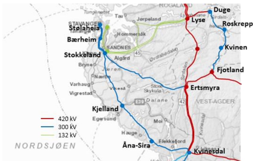
Figur 10 Transmisjonsnettet i Sør-Rogaland og deler av Vestre korridor når de konsesjonssøkte tiltakene er gjennomført.
