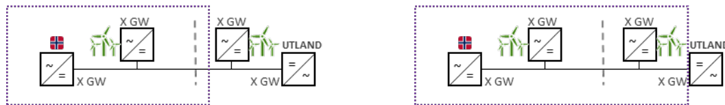
Figur 13: Topologier hvor omfanget for havvindutbyggingen stopper ved tilknytning til en omformerstasjon i utenlandsk farvann (til venstre) eller ved tilknytning til en multiterminal HVDC-stasjon på land i utlandet (til høyre).
