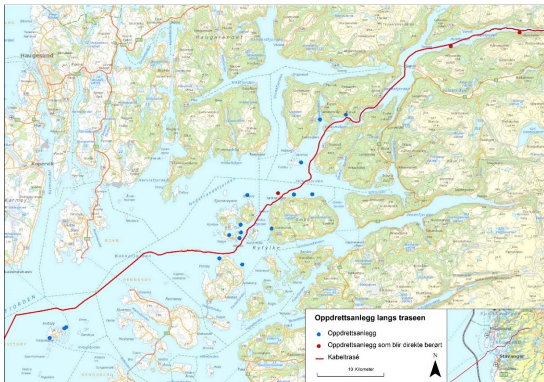
Figur 6 Oppdrettsanlegg langs kabeltraséen mellom Hylsfjorden og ytre Boknafjord. Røde punkter er oppdrettsanlegg med forankringer som kan komme i direkte konflikt med kabelen.
