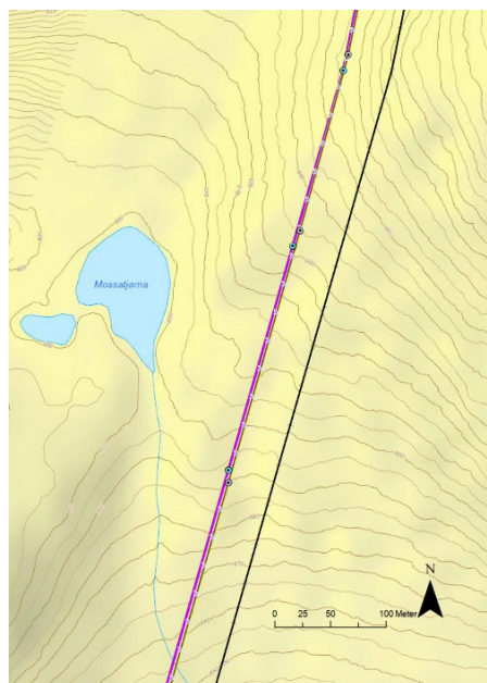
Figur 1: Kartutsnitt som viser eksempel på plassering av nye master i 300 kV traseen.
