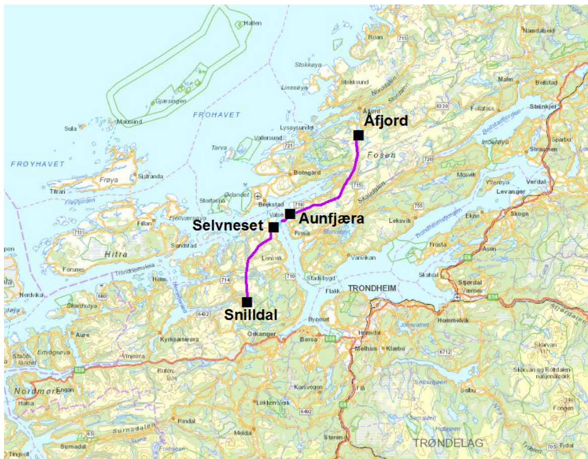
Figur 4-2: Oversiktskart som viser den konsesjonsgitte 420 kV ledningstraseen mellom Åfjord og Snilldal transformatorstasjoner.
