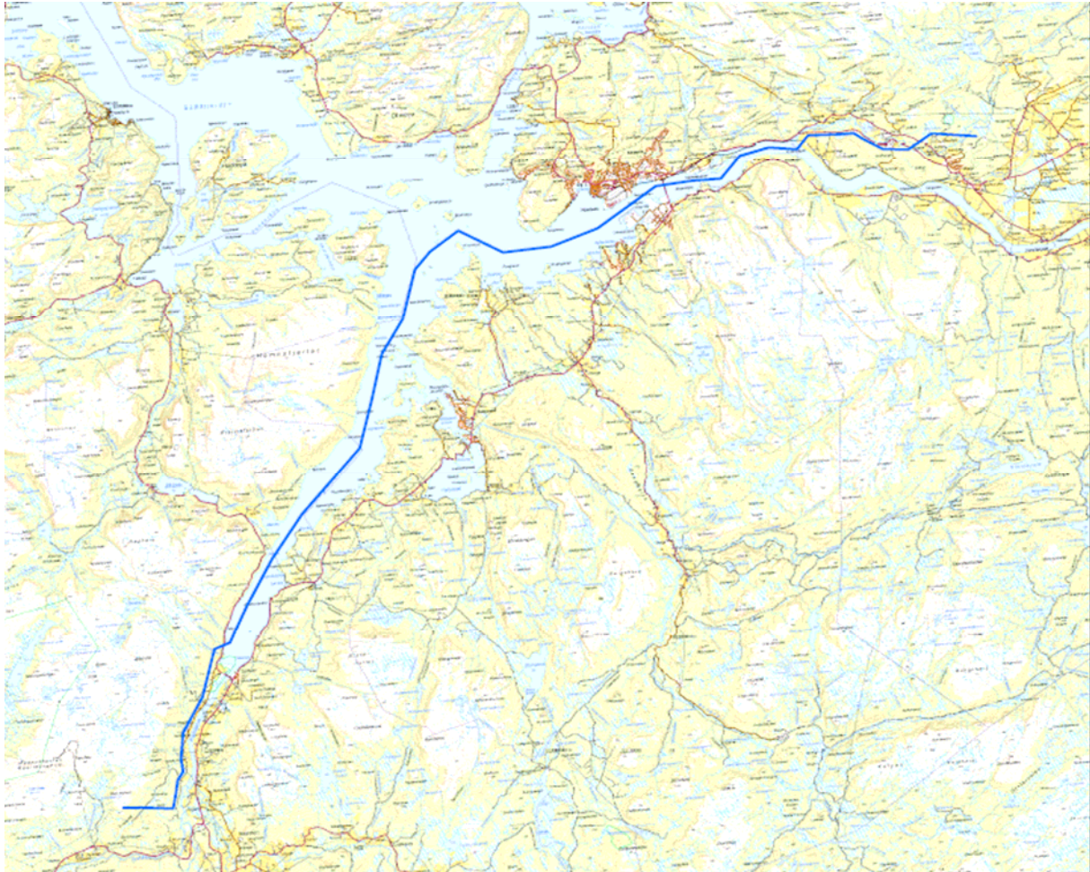
Figur 25. Illustrasjon av mulig trasé for sjø/landkabel på strekningen Namsos transformatorstasjon i Overhalla kommune til Mekveldheia/Straumingsåsan i Namdalseid kommune.
