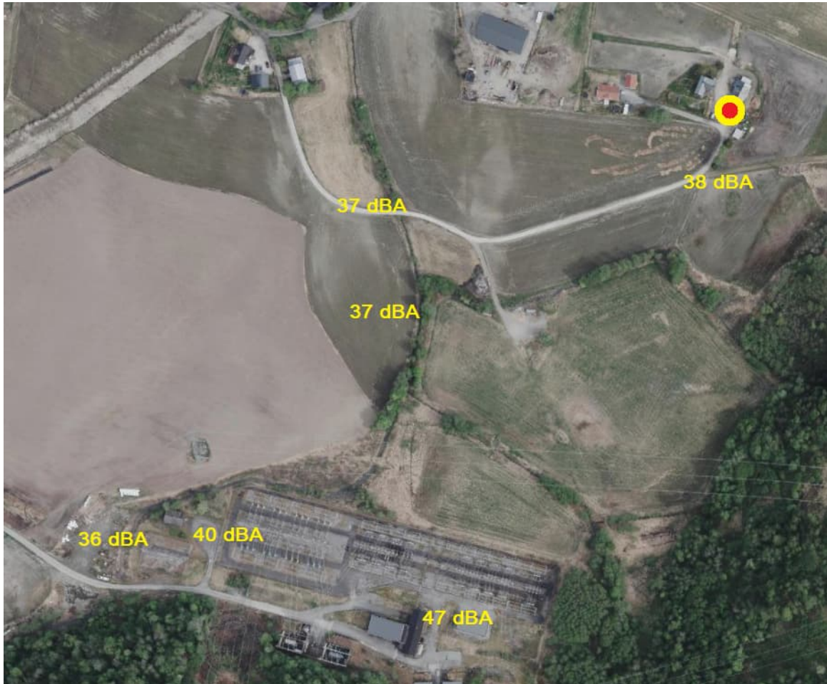
Figur 4: Utvalg av målepunkter. Permanent målestasjon markert med gult/rødt
