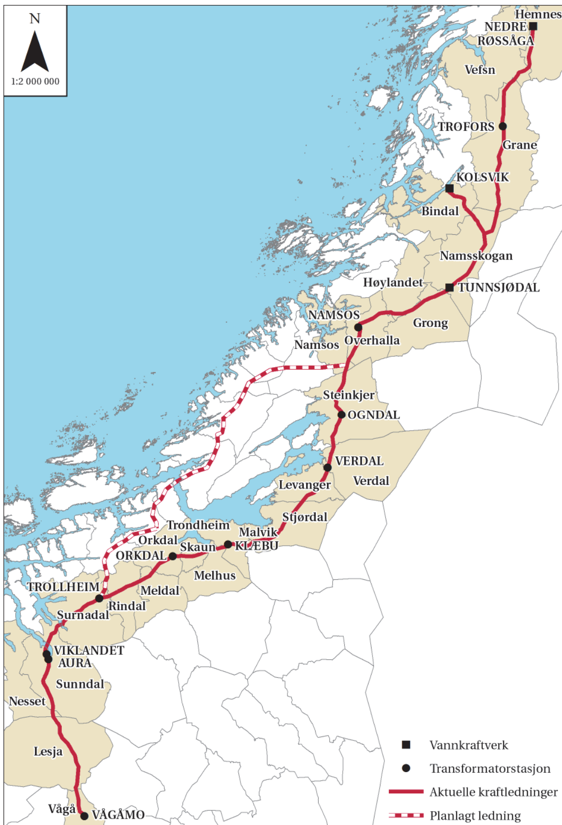
Figur 2: Aktuelle ledninger som planlegges oppgradert i prosjektet spenningsoppgradering Midt-Norge. Heltrukken linje er eksisterende 300 kV-ledning som skal oppgraderes til 420 kV. Stiplet linje er planlagt og konsesjonsgitt ledning som er nødvendig for at konsesjonsgitt vindkraft skal kunne bygges ut.
