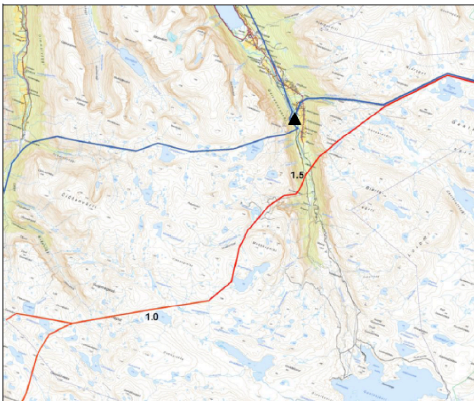
Figur 6.9 Planskisse for traséføring gjennom seksjonen. Traséalternativ 1.5 – 1.3 er vist med rød strek. Eksisterende stasjon er vist med sort trekant. Eksisterende 132 kV-ledninger er vist med blå strek. Kilde: Statnett 25.11.2008.
