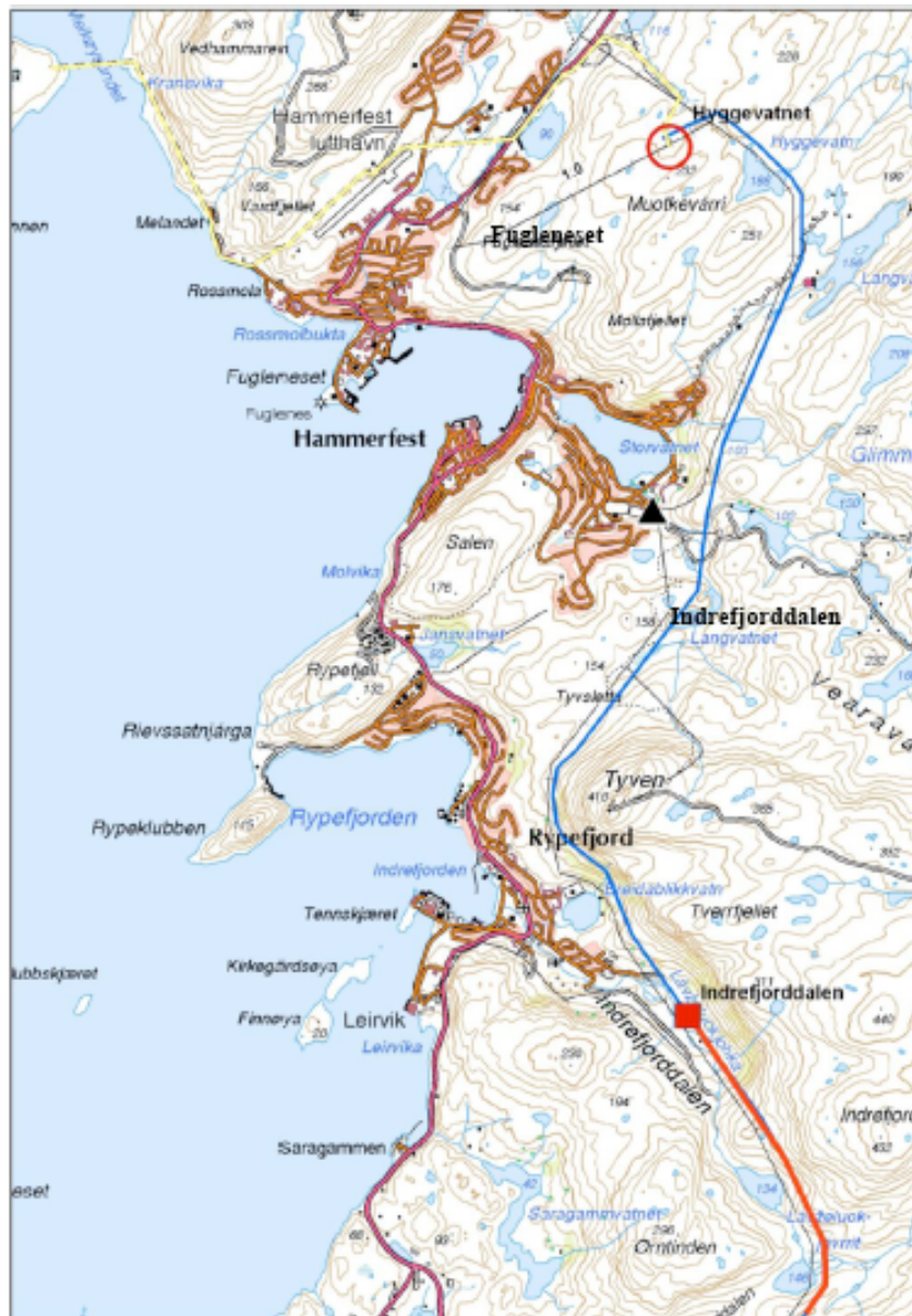
Figur 6.23 Kartutsnittet viser planlagt trasé for 420- og 132 kV-forbindelsene mellom Repparfjorddalen og Melkøya. Rød og blå streker er traséene til planlagte 420- og 132 kV-ledninger. Gul stiplet strek indikerer 132 kV-kabel. Planlagt stasjon i Indrefjorddalen er vist med rød firkant, planlagt stasjon ved Hyggevatn med rød ring og eksisterende stasjon med sort trekant. Eksisterende 132 kV-ledninger er vist med sort strek. Kilde: Statnett 25.11.2008.
