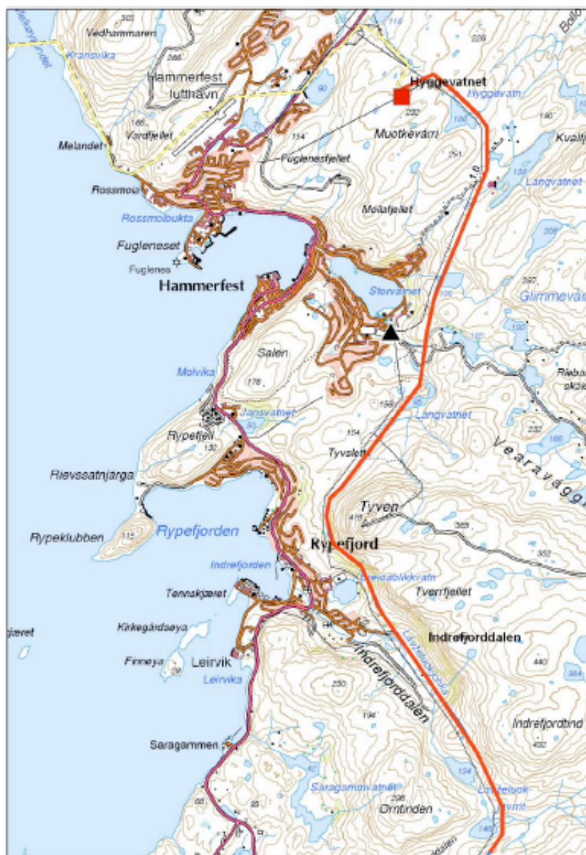
Figur 6.24 Kartutsnittet viser planlagt trasé 1.A for 420- og 132 kV-forbindelsene mellom Ryparfjorddalen og Melkøya. Rød strek er traséen til planlagt 420 kV-ledning. Gul stiplet strek indikerer 132 kV-kabel. Planlagt stasjon ved Hyggevatn er vist med rød firkant, og eksisterende stasjon med sort trekant. Eksisterende 132 kV-ledninger er vist med sort strek. Kilde: Statnett 25.11.2008.
