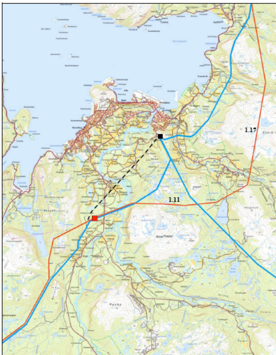
Figur 6.16 Planskisse for traséføring gjennom seksjonen. Planlagt traséalternativ 1.0 – 1.1.1 – 1.17 for 420 kV-ledningen er vist med rød strek. Traséene for 132 kV-ledningene slik det vil se ut etter at transformatorstasjonene på Skillemoen (rød firkant) er etablert, er vist med blå streker. Sort stiplet strek viser traséen til den eldste 132 kV-ledningen som rives. Eksisterende stasjon på Raipas er vist med sort firkant. Kilde: Statnett 25.11.2008.
