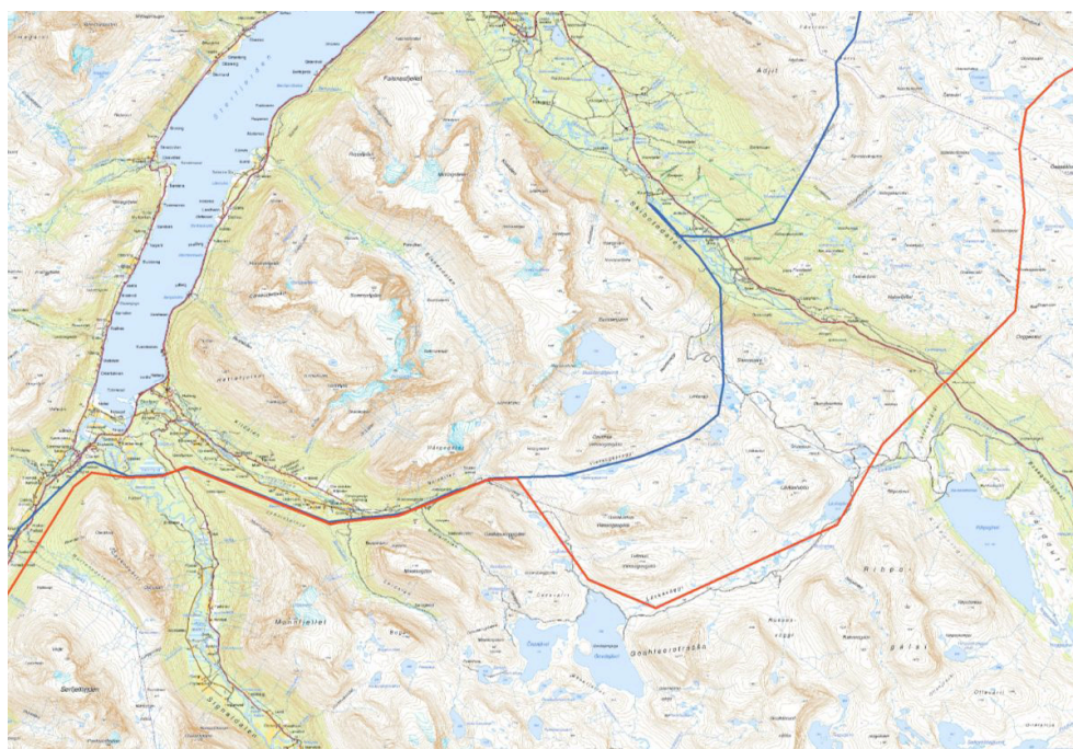
Figur 6.4. Planskisse for traséføring gjennom seksjonen. Alternativ 1.0 - 1.19 (rød strek). Eksisterende 132 kV-ledning er vist med blå strek. Kilde Statnett 25.11.2008.
