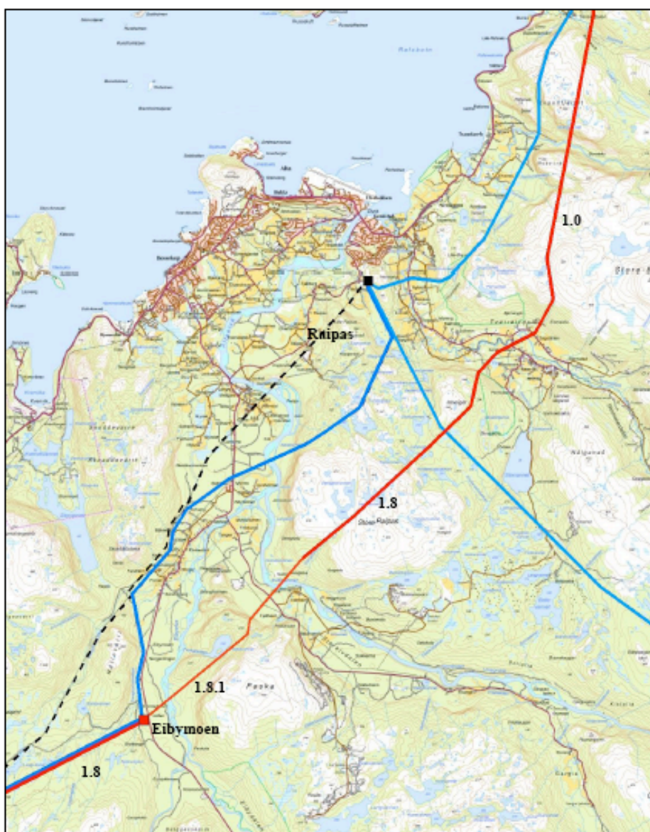
Figur 6.17 Planskisse for traséføring gjennom seksjonen. Traséalternativ 1.8 – 1.8.1 - 1.8 – 1.0 med omlegging av eksisterende 132 kV-ledninger inn til Eibymoen og ny 132 kV-ledning til Raipas. 420
