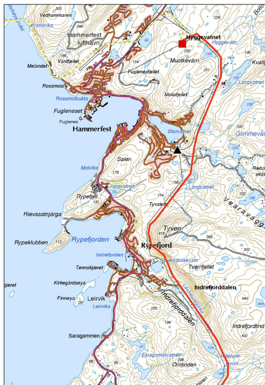
Figur 2-26: Kartutsnittet viser alt. 1.A i seksjon 8. Rød strek er traseen til planlagt 420 kV-ledning. Gul stiplet strek indikerer 132 kV-kabel. Planlagt stasjon ved Hyggevatn er vist med rød firkant, og eksisterende stasjon med sort trekant
