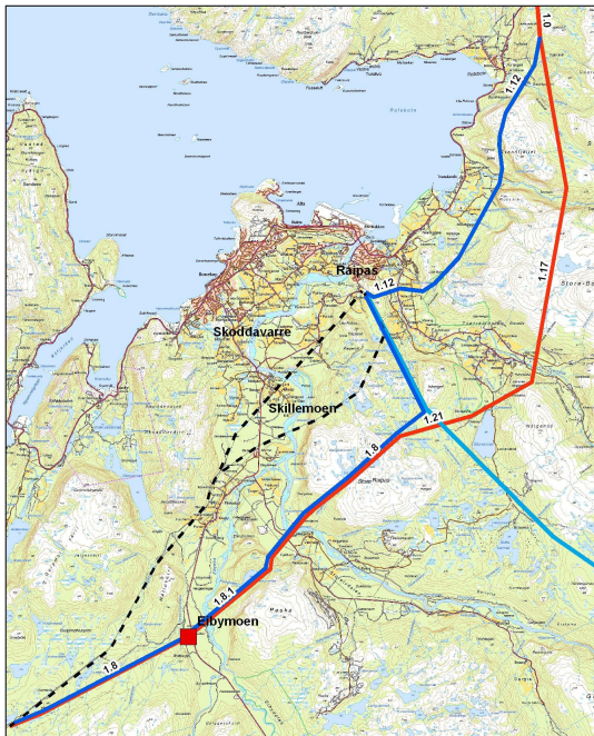
Figur 2-23: Alternativ 1.8–1.8.1–1.21–1.17 A med omlegging av eksisterende 132 kV-ledninger inn til Eibymoer. Derfra går én ny 132 kV-ledning (blå strek) parallelt med ny 420 kV-ledning i ny trasé over Store Raipas. Deretter følger 132 kV-ledningen ledningen fra Alta kraftverk (lys blå strek) inn mot Raipas. 420 kV-ledningen er vist med rød strek. Sort stiplet strek viser traseene til eksisterende 132 kV-ledninger, som rives. Eksisterende stasjon Raipas ligger rett under "Raipas" i kartet
