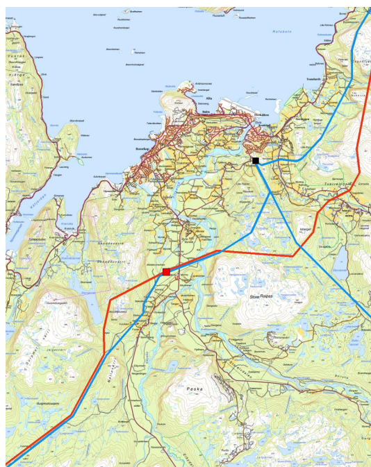
Figur 2-17: Alternativ 1.0–1.1.1–1.8–1.0 for 420 kV-ledningen i seksjon 5 er vist med rød strek. Traseene for 132 kV-ledningene slik det vil se ut etter at transformatorstasjonene på Skillemoen (rød firkant) er etablert er vist med blå streker. Sort stiple strek viser traseen til den eldste 132 kV-ledningen som rives. Eksisterende stasjon på Raipas er vist med sort firkant
