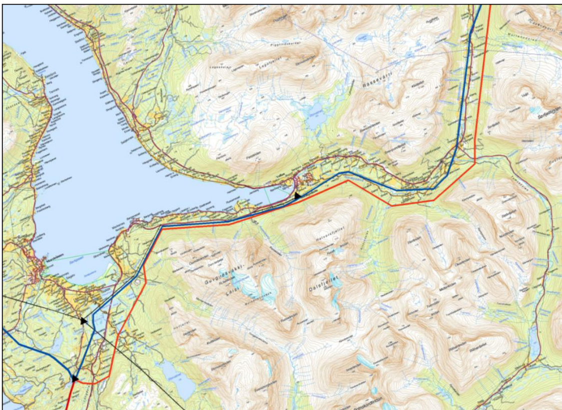
Figur 2-3: Alternativ 1.0 for planlagt 420 kV-ledning i seksjon 1 er vist med rød strek. Eksisterende 132 kV-ledninger er vist med blå strek og eksisterende 66 kV-ledningen med sort strek. Sorte trekkanter er eksisterende stasjoner
