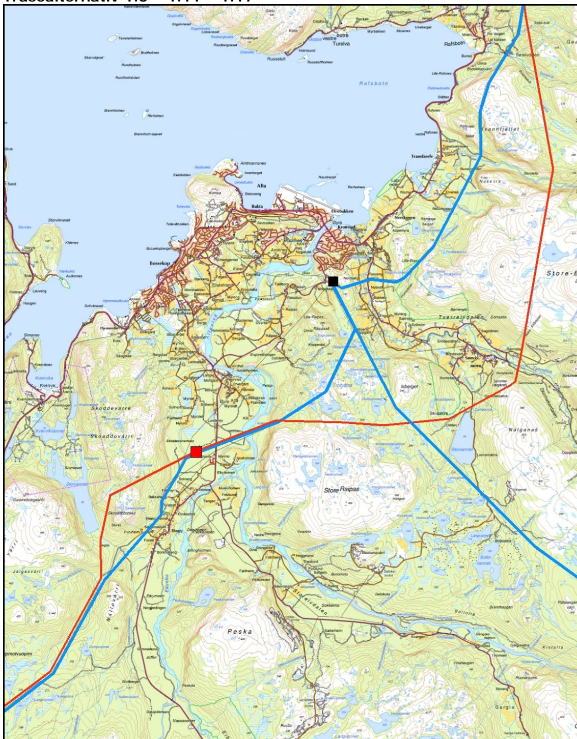
Figur 17: Planlagt traséalternativ 1.0 – 1.1.1 – 1.17 for 420 kV-ledningen er vist med rød strek. Traséene for 132 kV-ledningene slik det vil se ut etter at transformatorstasjonene på Skillemoen (rød firkant) er etablert er vist med blå streker. Sort stiplet strek viser traséen til den eldste 132 kV-ledningen som rives. Eksisterende stasjon på Raipas er vist med sort firkant
