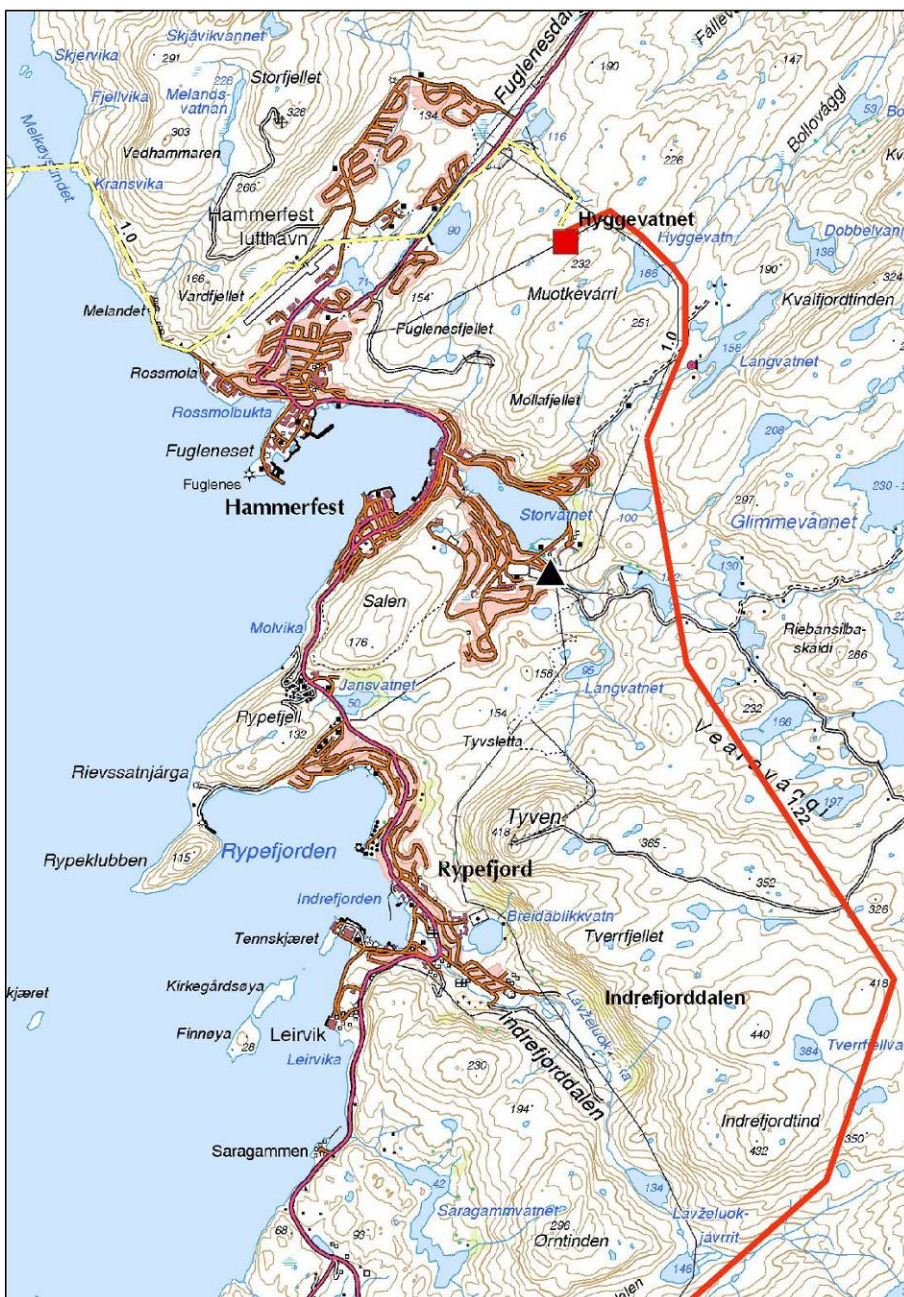
Figur 26: Kartutsnittet viser planlagt trasé 1.22 – 1.0 for 420- og 132 kV-forbindelsene mellom Repparfjorddalen og Melkøya. Rød strek er traséen til planlagt 420 kV-ledning. Gul stiplet strek indikerer 132 kV-kabel. Planlagt stasjon ved Hyggevatn er vist med rød firkant, og eksisterende stasjon med sort trekant. Eksisterende 132 kV-ledninger er vist med sort strek.
