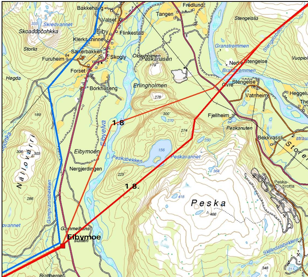
Figur 19: Alternativ 1.8 forbi Peska. Traséen til 420 kV-ledningen er vist med rød strek. Blå strek viser omlagt 132 kV-ledning om Eibymoen. Fra litt før Furuheim brukes eksisterende 132 kV-ledning videre til Raipas. Se også neste kartbilde.
