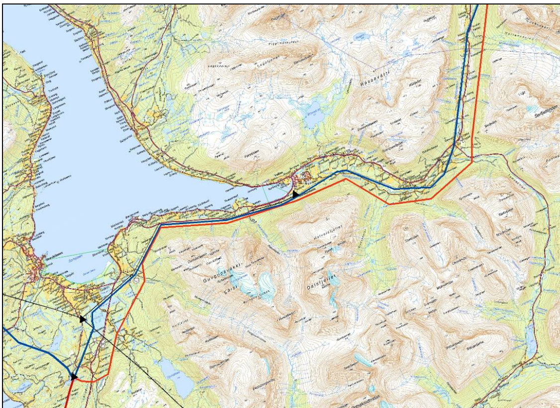
Figur 2: Traséalternativ 1.0 for planlagt 420 kV-ledning i Balsfjord er vist med rød strek. Eksisterende 132 kV-ledninger er vist med blå strek og eksisterende 66 kV-ledningen med sort strek. Sorte trekkanter er eksisterende stasjoner.
