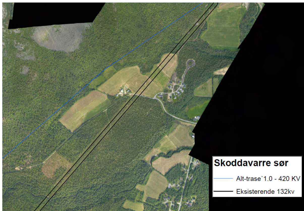
Figur 12 Utsnittet viser vurdert traséalternativ i lia mot Skoddavarre. Ledningen vil passere ca 170 meter fra nærmeste bolighus på gården Furuheim, som vil bli inneklemt mellom 2 stk 132kv ledninger på sørsiden og ny 420Kv på nordsiden.
