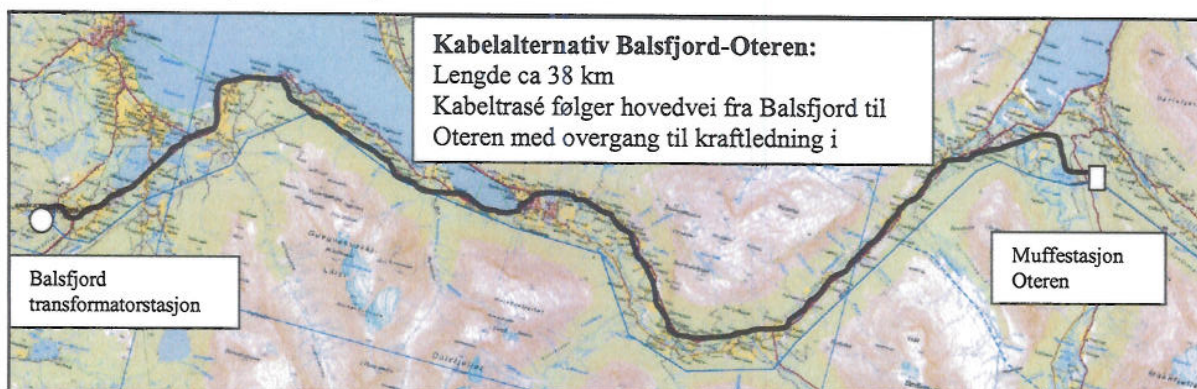
Figur 13: Jordkabel 420 kV Balsfjord-Oteren med muffestasjon i Oteren
