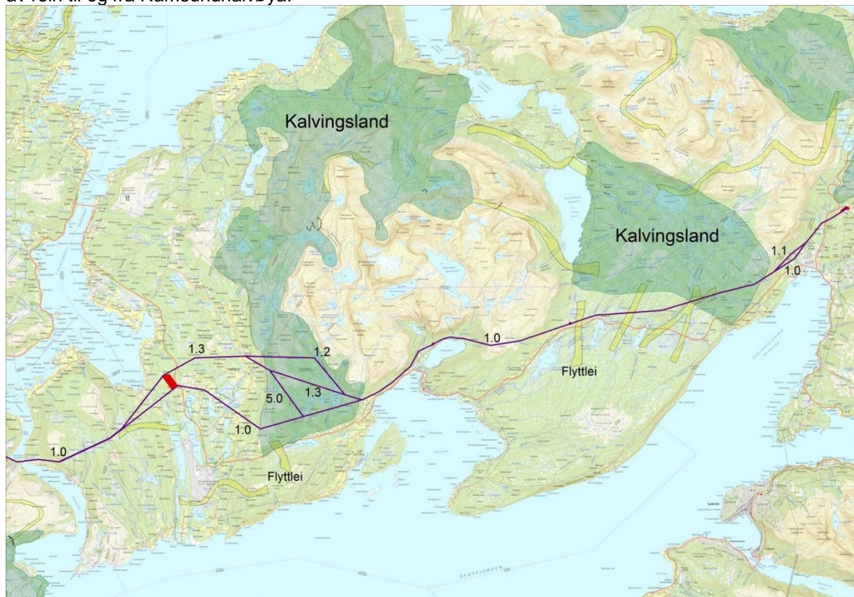
Figur 10-1 Oversikt over Statnetts planlagte tiltak, med alternativer, innenfor deler av Grovfjord rbd. sitt konsesjonsområde. Lilla linjer viser alternative 132 kV linjer, røde polygon viser trafostasjoner. Grønn skravur viser kalvingsland, mens gule polygon viser flyttleier. For oversikt over andre beiteområder henvises det til reindriftskart.
