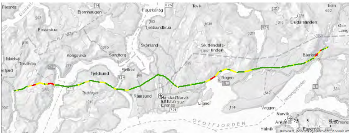
Figur 6-2 Vurdering av skredfare med returperiode 1000 år langs eksisterende linje Kvandal-Kanstadbotn. Grønn=lav fokus, gul=middels fokus og rød=høy fokus.
