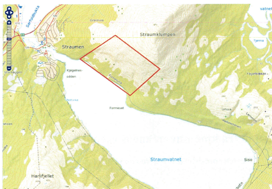
Figur 1. Området innenfor rødt polygon er kartlagt av NGI mht. skredfare for ulike skredtyper. Når det gjelder kilder for sørpeskred er hele fjellsiden opp til toppen vurdert. (Kilde: Statens kartverk).
