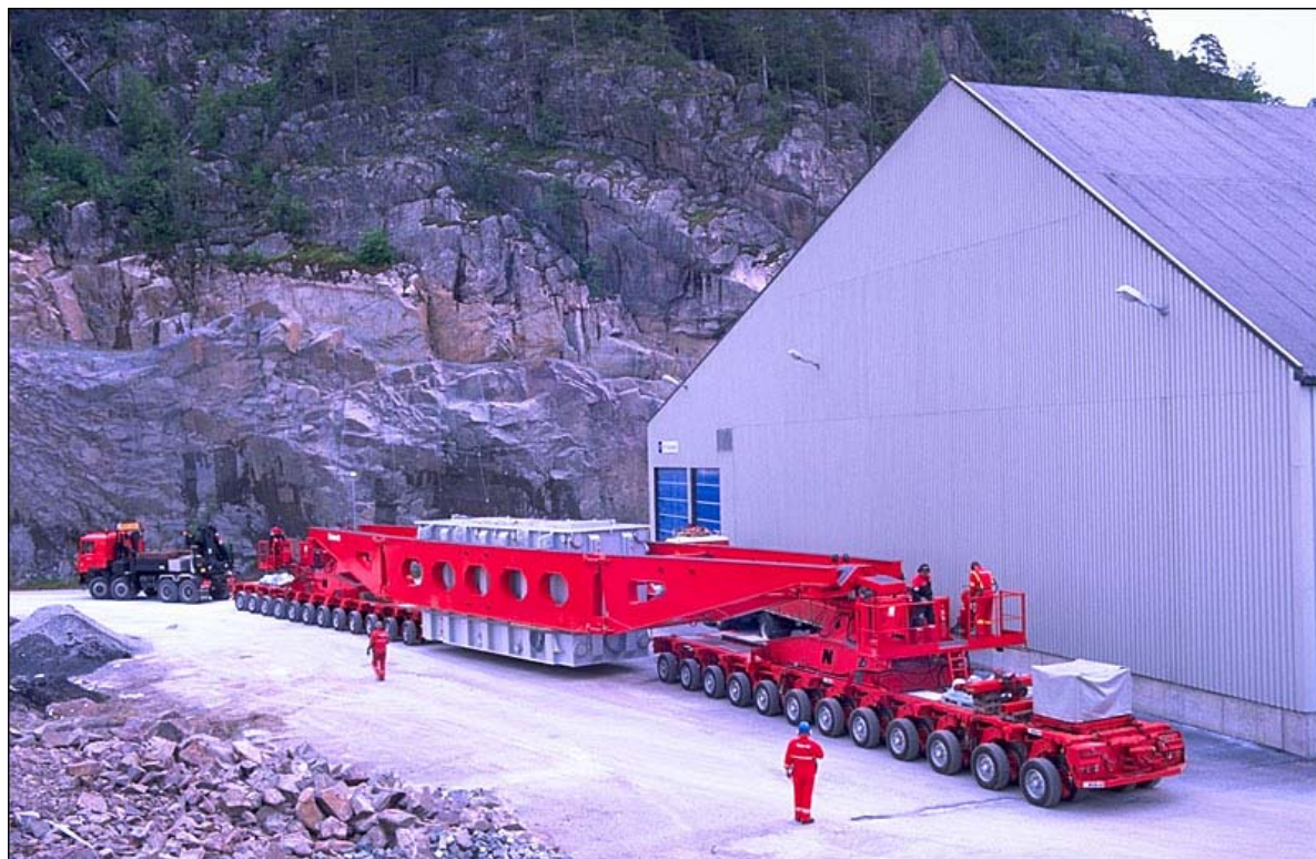
Bilde 1: Typisk Statnett transformatortransport ( www.statnett-transport.no ).
