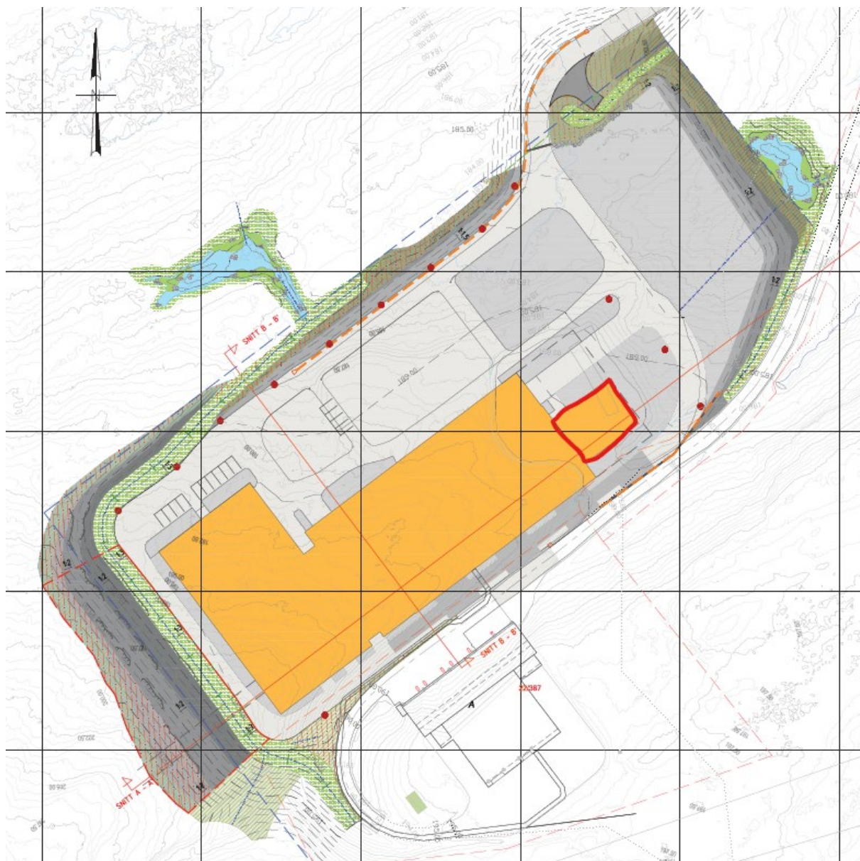
Figur 4. Landskapsplan Hyggevatn transformatorstasjon. Reservetrafo er markert med rødt. Statnett vil tilleggssøke konsesjon for utvidelse av bygget med areal til reservetrafo.
