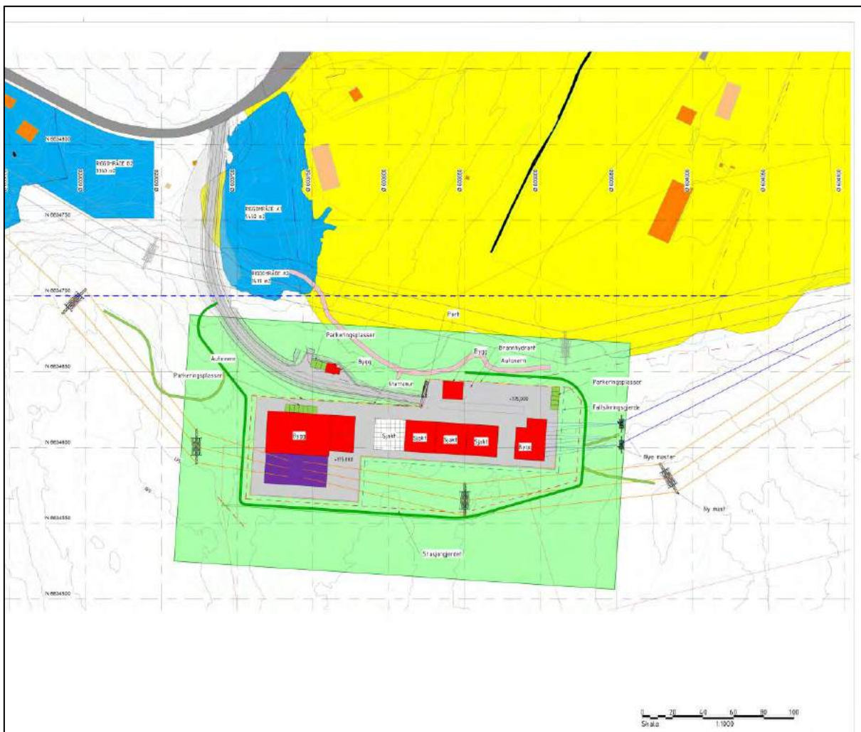
Figur 2-1: Foreløpig situasjonsplan for Liåsen transformatorstasjon, alternativ A.
