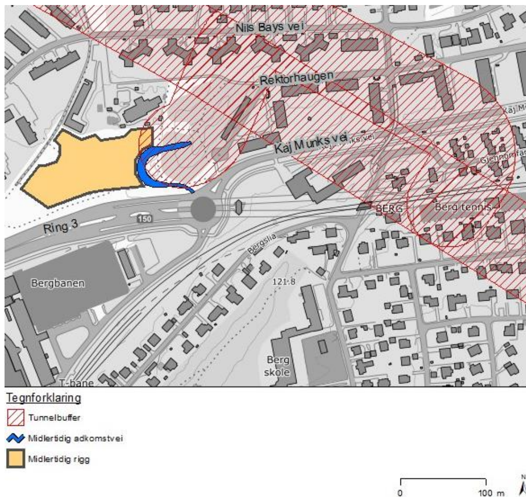
Figur 9: Planlagt riggområde og midlertidig atkomstvei ved tverrslag Tåsen (Rektorhaugen). Se mer detaljert kart i vedlegg 1.
