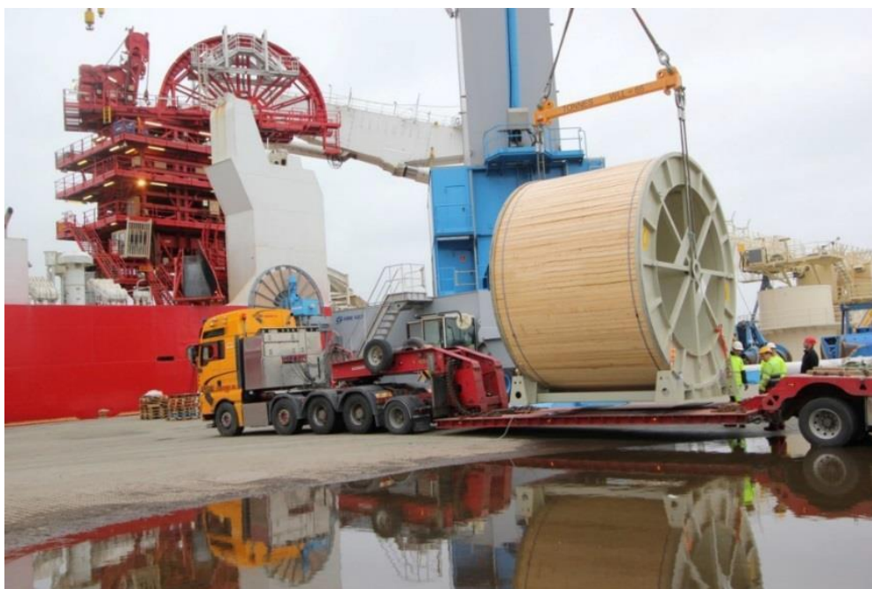
Figur 13: Spesialtransport av kabeltromler
