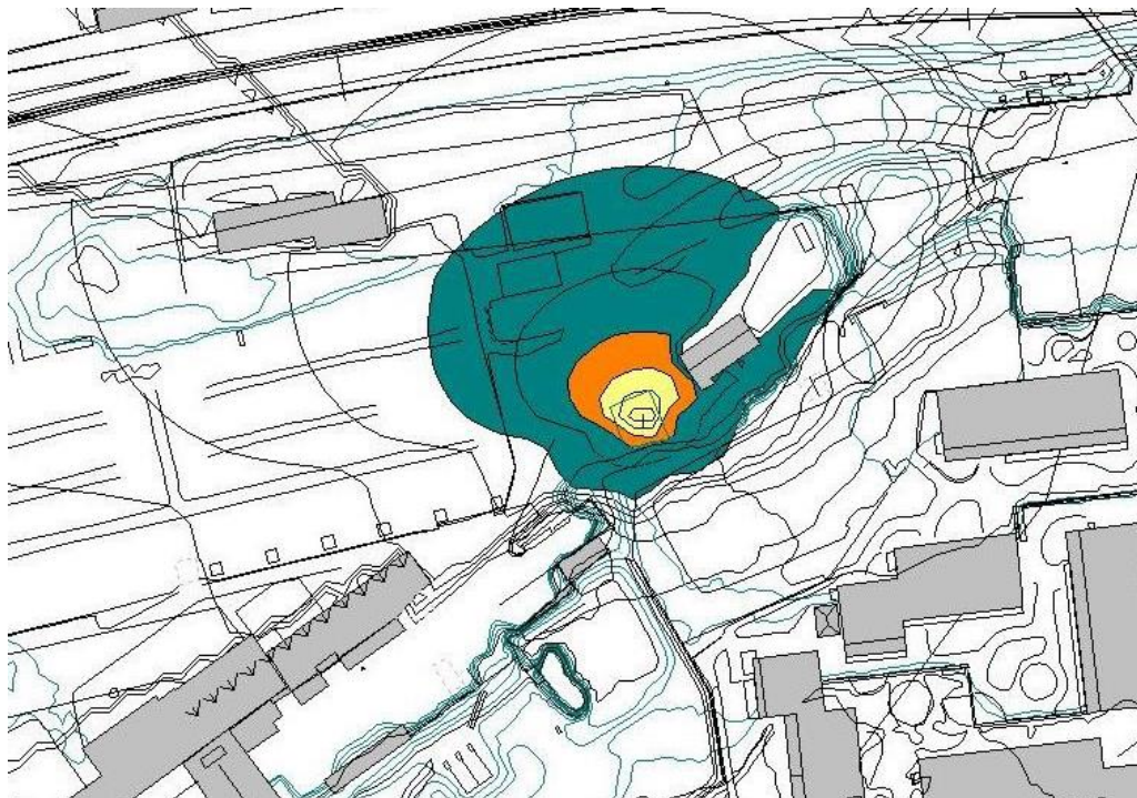
Figur 17: Støyberegning av tunnelvifte ved tverrslag ved Ulven. Gul sone > 70 dB (grense dag), oransje sone 65 dB (grense kveld), grønn sone >55 dB (grense natt).
