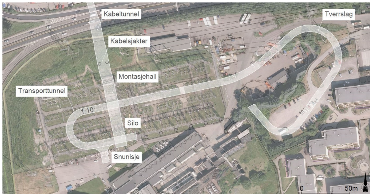
Figur 10: Forslag til tunnelarrangement ved Ulven. Arrangementet omfatter tverrslag/adkomsttunnel, kabelsjakter, montasjehall for TBM, transporttunnel, omlastehall med silo og snunisje.
