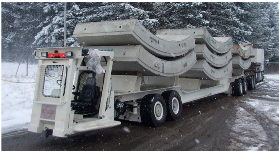
Figur 8: Eksempel på spesialkjøretøy/MSV, benyttet for inntransport av betongsegmenter.
