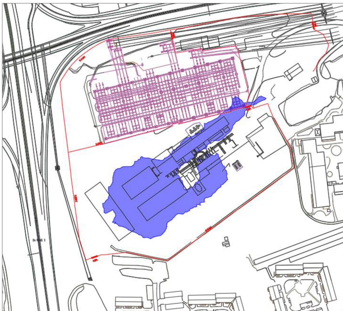
Figur 4 Det blå området vil ha et magnetfelt over utredningsnivået på 0,4 \mu\text{T} .
