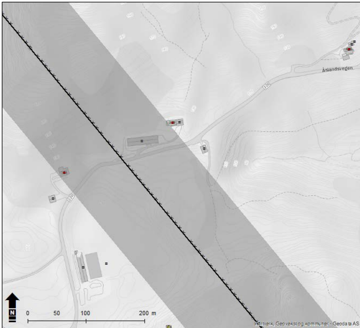
Område 12: Bygninger innenfor 100 m korridor for 300 kV Tonstad som skal saneres. Strekning fra Husaberget til Åslandsnuten.
