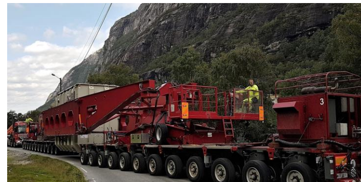
Sikkerheten kommer alltid først, også når vår 220 tonn tunge transformator ble fraktet til Lyse stasjon.
