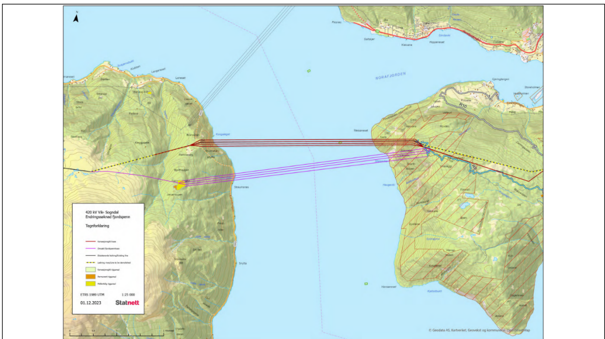
Figur 2: Oversiktskart for fjordspenn over Sognefjorden. Jarvehaugen i Vik kommune ligger på vestsiden. Bjørnstigkamben i Sogndal kommune ligger på østsiden. Øverst, med sorte streker, er 300 kV ledning mellom Sogndal og Hove som skal rives. Nederst, med blå streker, er ledningen som Statnett nå har fått konsesjon til.
