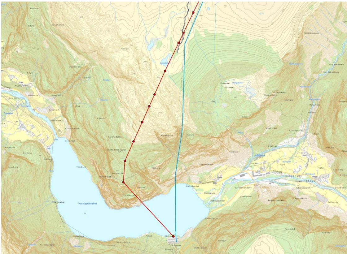
Figur 9. På strekningen mellom Lomatjernet via Kamben til Aurland transformatorstasjon er traseen flyttet vestover. Rød ledning og røde punkt er ny trasé og mastepunkter.
