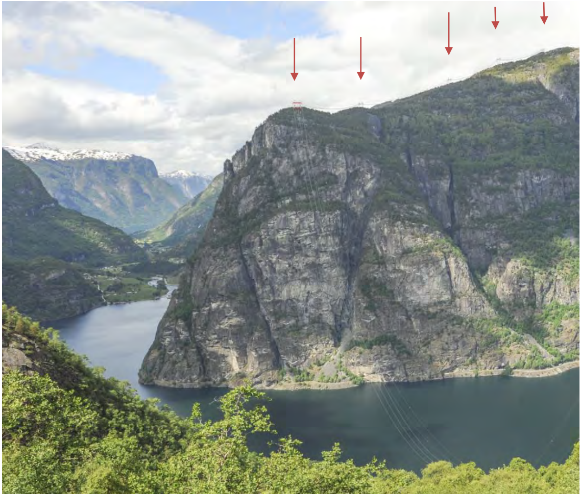
Figur 4-56 Visualisering av ny trasé sett fra Fv 50 som viser at ny ledning vil komme midt i synsfeltet for utsikten mot Aurland. Master på begge sider av spennet over vannet må flymerkes i henhold til dagens merkekrav. Fem master vil bli synlig i silhuett på Kamben og innover mot Vindeggi.
