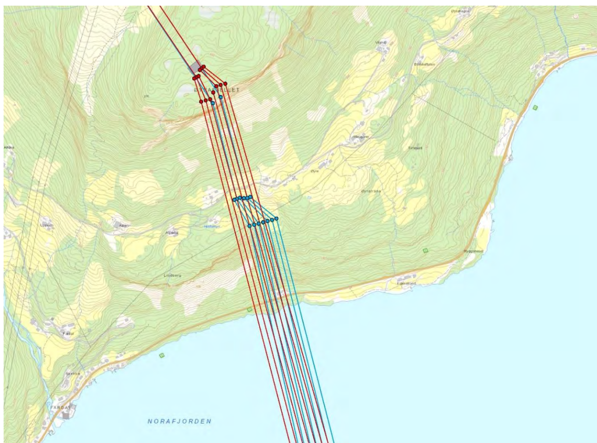
Figur 2-3 To ulike løsninger for plassering av endemaster på Øyrefjellet/Alpen. Alt. 1a med høy kryssing (rød) og alt. 1b med lav kryssing (blå). Baseplass er tegnet inn med grå farge.
