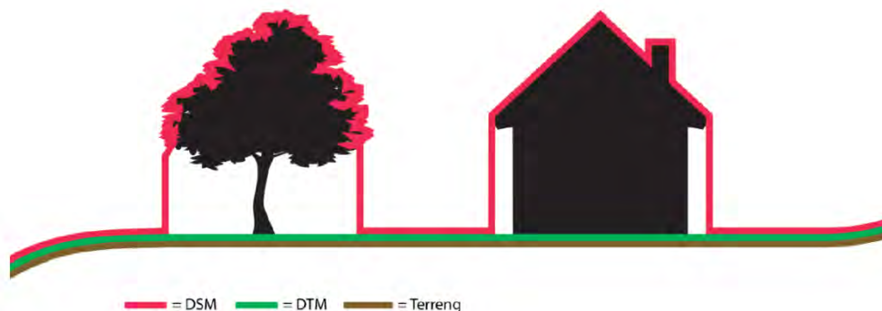
Figur 6-4 Illustrasjonen viser forskjellen mellom overflatemodell (DOM (her DSM)) og terrengmodell (DTM), og hvordan DOM-scanningen oppfatter de ulike elementene (Kilde: NIKU 2016).
