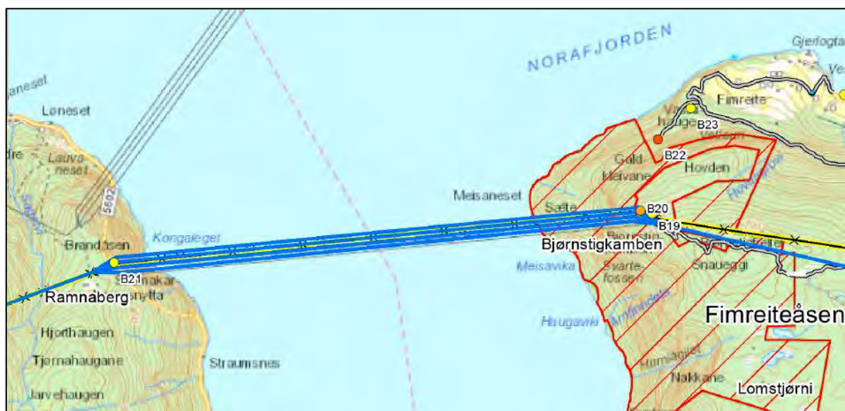
Figur 3-1 Konsesjonsgitt løsning med nye 420 kV luftledninger fra Ramnaberget mot sørvest og Bjørnstigkamben og sørøstover, samt nytt 420 kV fjordspenn i dagens trasé (III: Statnett, anleggskonsesjon 201305024; 202106011).
