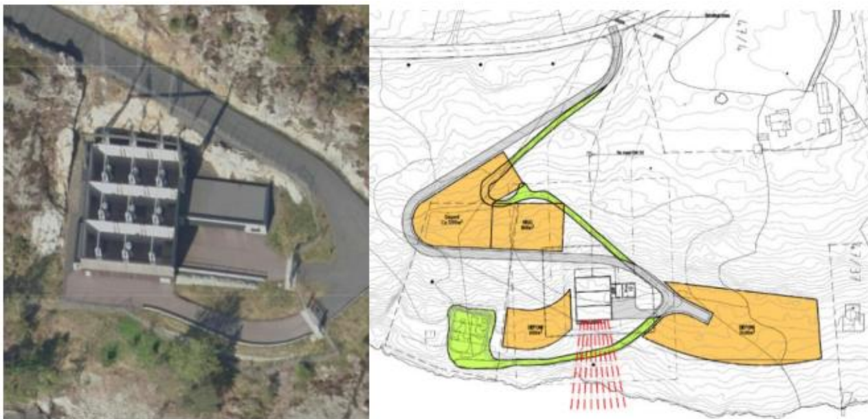
Figur 2-5. Eksempel på muffestasjon fra Indre Oslofjord.
