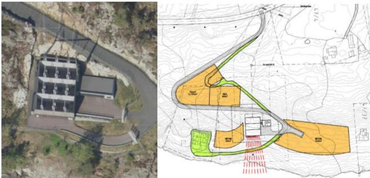
Figur 2-5. Eksempel på muffestasjon fra Indre Oslofjord.
