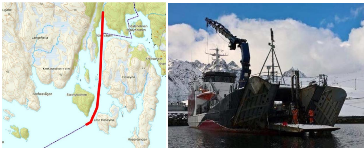
Figur 4: Strekning for plassering av betongmadrasser til venstre. Typisk fartøy for installasjon av madrasser til høyre.
