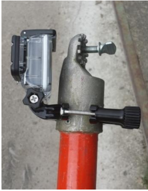
Montasje av kamera på isolerstang.
